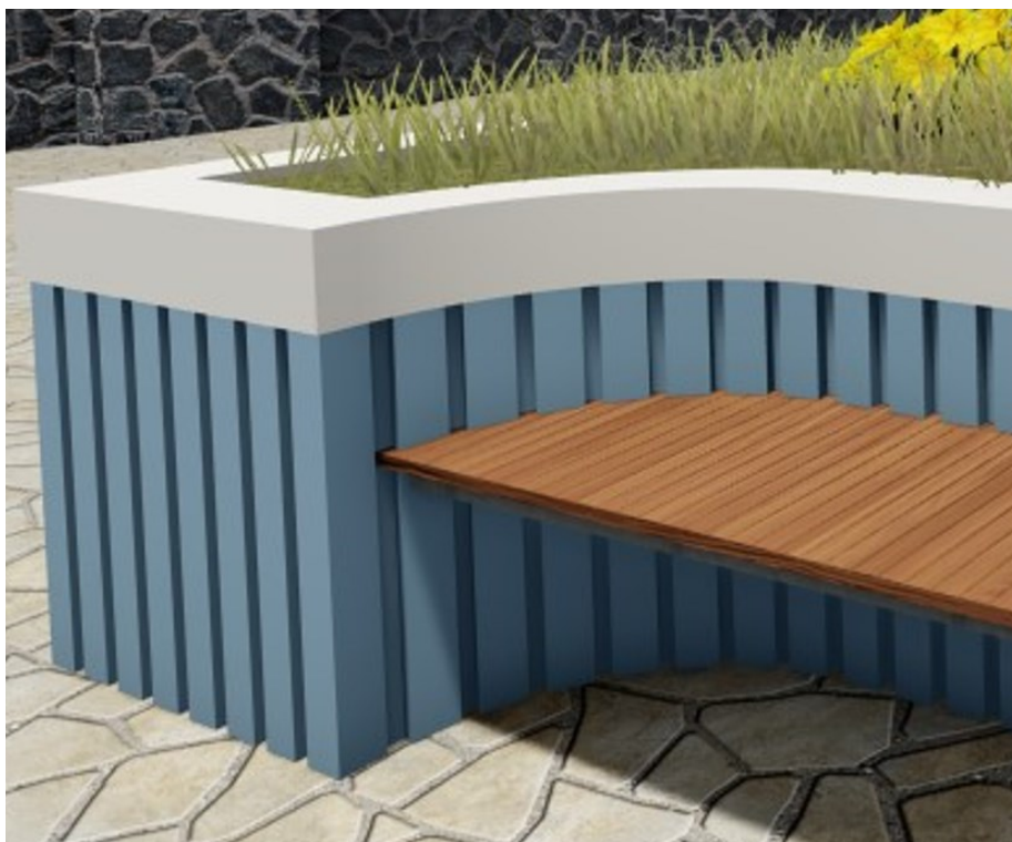
Figura 3 - ilustração do acabamento em argamassa dos canteiros tipo "alto"
